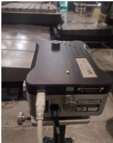
激光干涉仪是激光的应用之一，它以激光波长为已知长度，利用迈克尔逊干涉系统测量位移的通用长度测量。激光干涉仪除了可以用来测量长度以外，如果配合各种折射镜、反射镜等来作线性位置、速度、角度、真平度、真直度、平行度和垂直度等测量工作，可作为精密工具机或测量仪器的校正工作。未来，激光干涉仪可从光源、探测器、信号处理系统、光学系统等方面进行发展，从测量数据的可靠性、精确性，以及测量仪器的便携性等，不断改善激光干涉仪的各项性能。广州激光干涉仪购买激光干涉仪哪种质量比较好？
